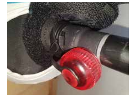
Foto 19: Slang met koppelstuk bevestigd aan ventiel.
