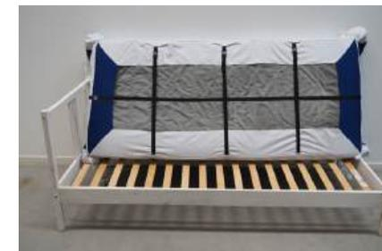
Foto 21: Befestigung der Gurte unter der Matratze.
